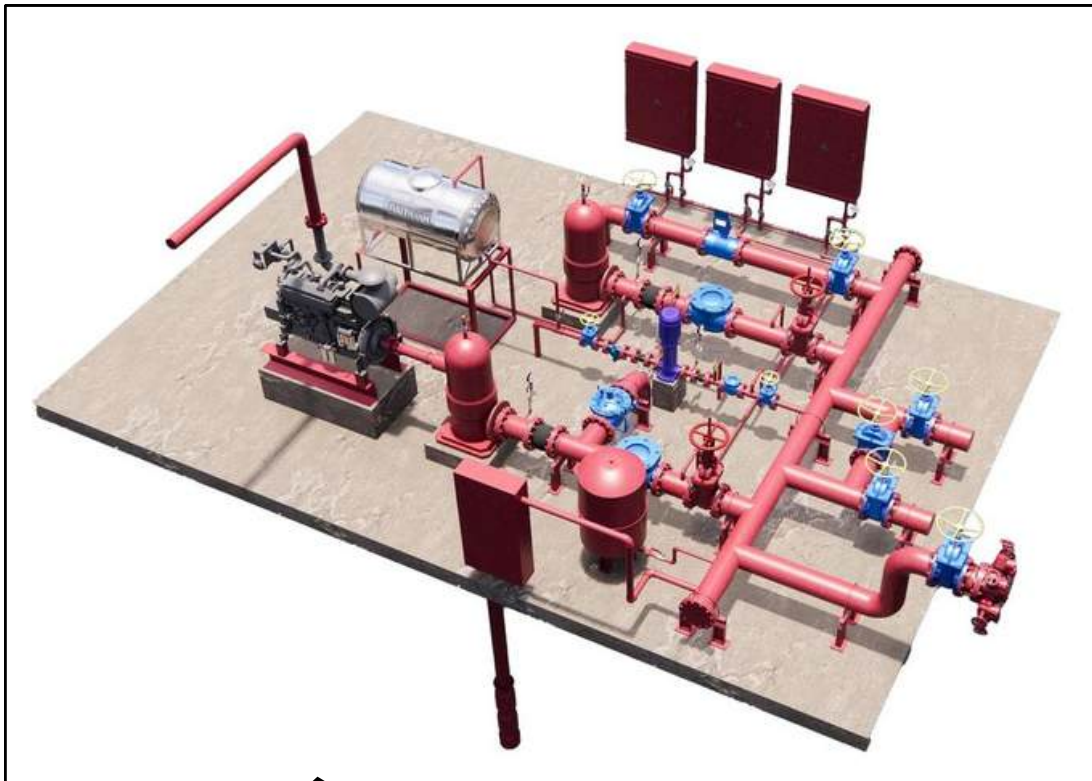
HỆ THỐNG BƠM CHỮA CHÁY
